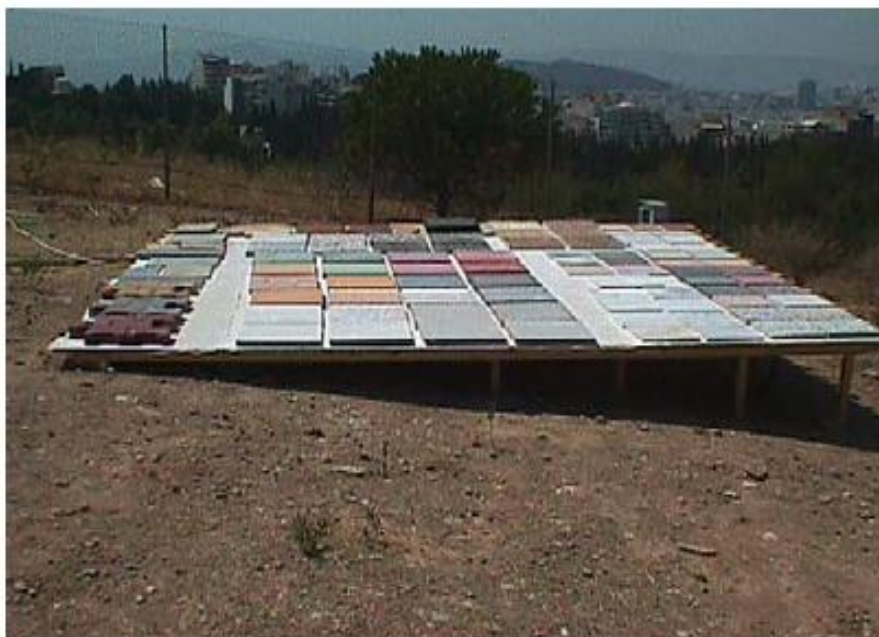
Figure 39: Les 93 matériaux testés par Doulos et al. (2004)
