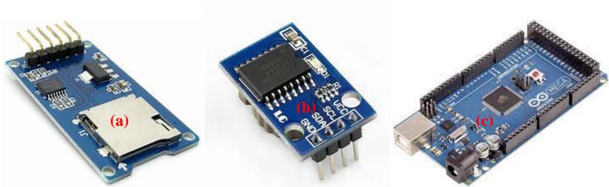
Figure 77: (a) Module micro-SD ; (b) Module RTC ; (c) Carte Arduino MEGA.
